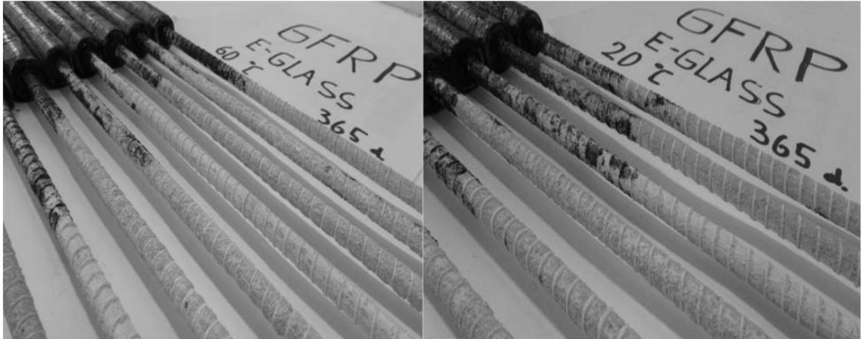
Obrázek 1: Vzorky výztuží GRFP-E po expozici alkalickému roztoku o teplotě 20°C (vpravo) a 60°C (vlevo) po dobu 365 dnů. Vzorky jsou po skončení expozice opatřeny koncovkami pro provedení tahových zkoušek.
