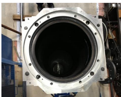
Obr. 9 Hybridní smykadlo s vnějším litinovým pláštěm a kompozitní výztuží.
