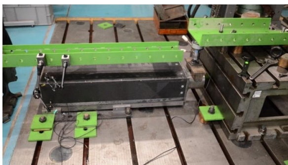
Obr. 7 Smykadlo při zkoušce tuhosti
