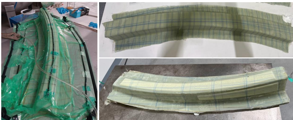
Obr. 3 Výroba monolitního omega profilu a profilu s PMI pěnovými vložkami.
