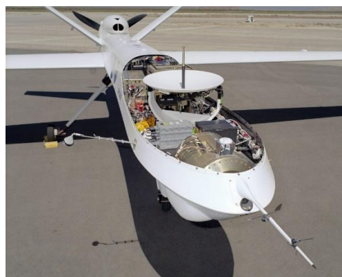
Obr. 2 Odkrytý radom na MQ-9
