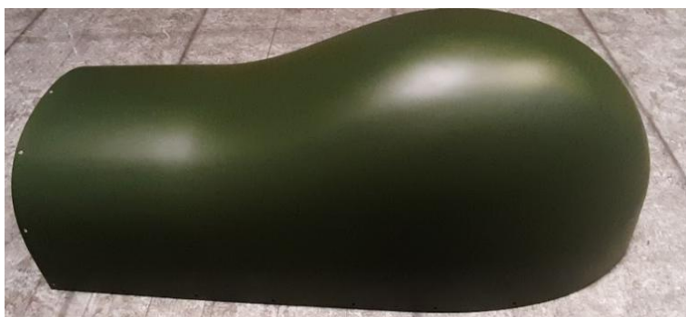
Obr. 9 Demonstrátor radomu s povrchovou úpravou
