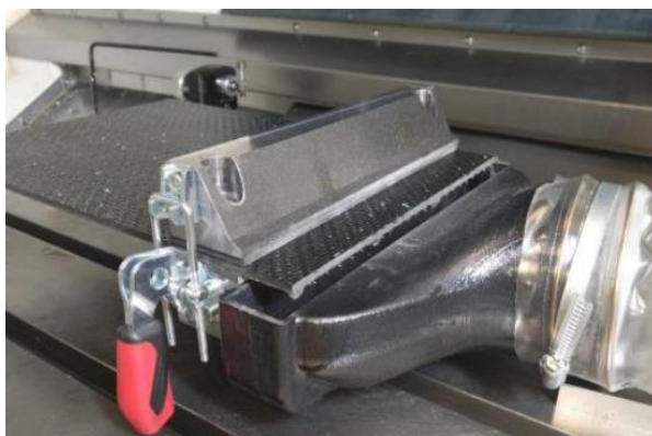
Obr. 1 Obrobek v upínacím přípravku
